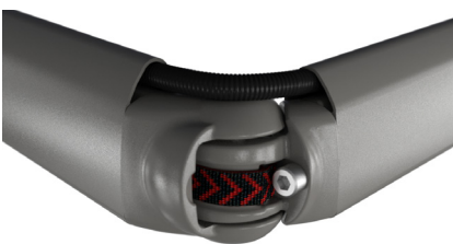
7 Bionic-Sehne und verdeckte Stromführung in den Armen
